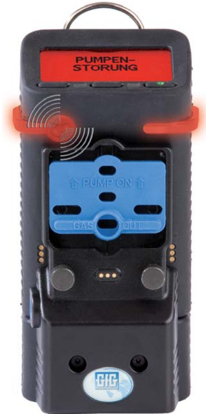
G460 mit aktivierter Pumpe: - Sensorabdeckung OBEN - Diffusionsöffnungen verdeckt
