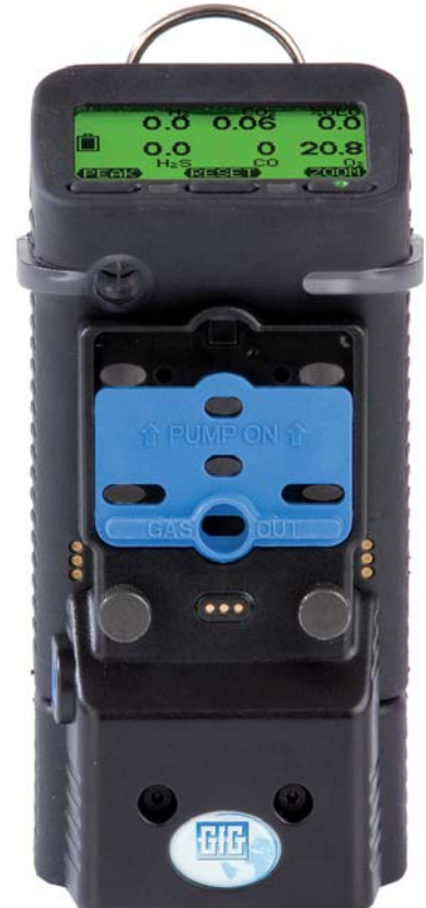
G460 mit deaktivierter Pumpe: - Sensorabdeckung UNTEN - Diffusionsöffnungen geöffnet
